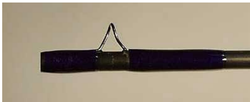
Valmis kärkiosan liitoskohta.
